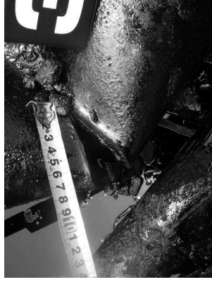
写真3 重油配管の開口部
