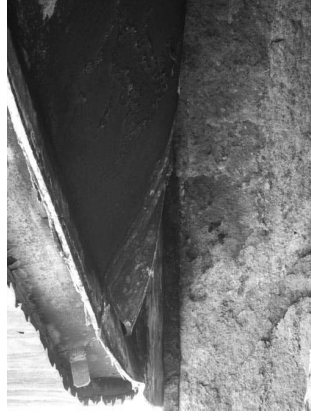
写真 24 硫黄タンクの底板の破断部
