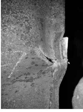
写真 43 ポンツーンの破断部（アウトターリムとローアードデッキの溶接線近傍）
