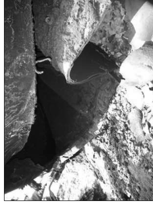
写真 19 ガソリントank破断部
