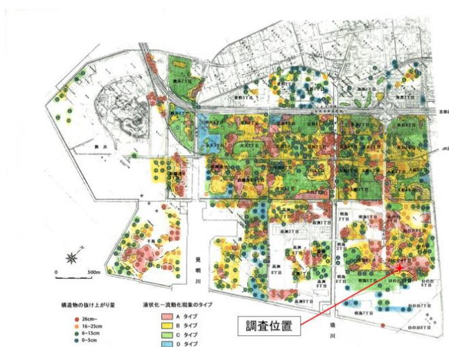
図 1 調査地と周囲の太平洋沖地震時の液状化－流動化現象のタイプの分布状況 2) 。タイプ区分については、表 1 を参照。
