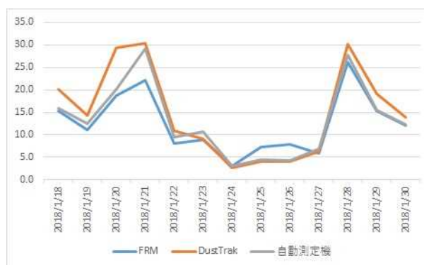
図5 FRM2025i，DustTrak，自動測定機の比較 （単位： \mu\text{g}/\text{m}^3 ）
